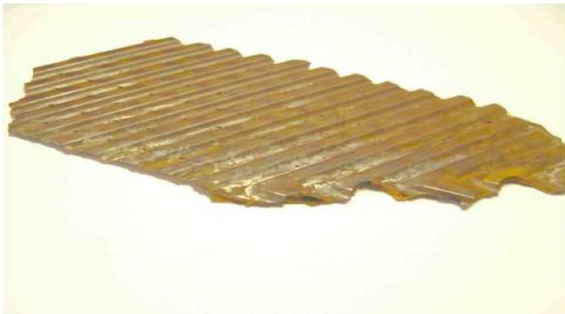
Рисунок 57 - Образец отложений, извлеченный из пластинчатого теплообменника (г. Сергач)
