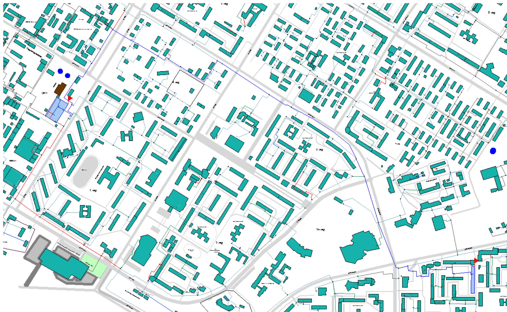
Рисунок 7 – Путь для построения пьезометрического графика участка от ЦК-1 (3-я очередь) до потребителя 12 мкр, д. 12
