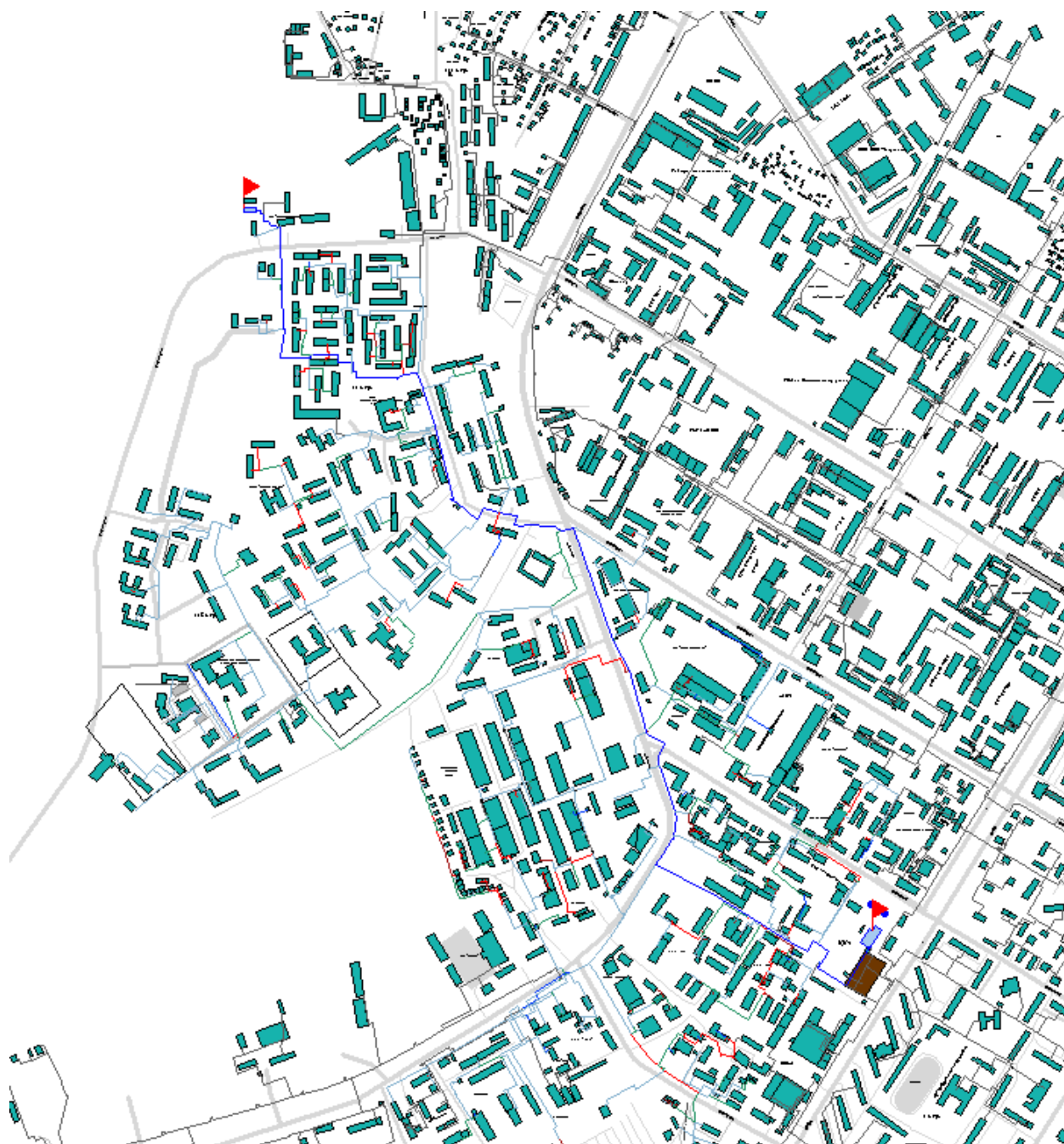
Рисунок 1 - Путь для построения пьезометрического графика участка от ЦК-1 (2-я очередь) до потребителя Склад №2
