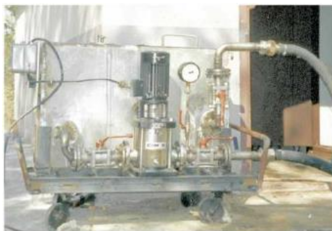
Рисунок 60 - Установка для химической промывки теплообменников
