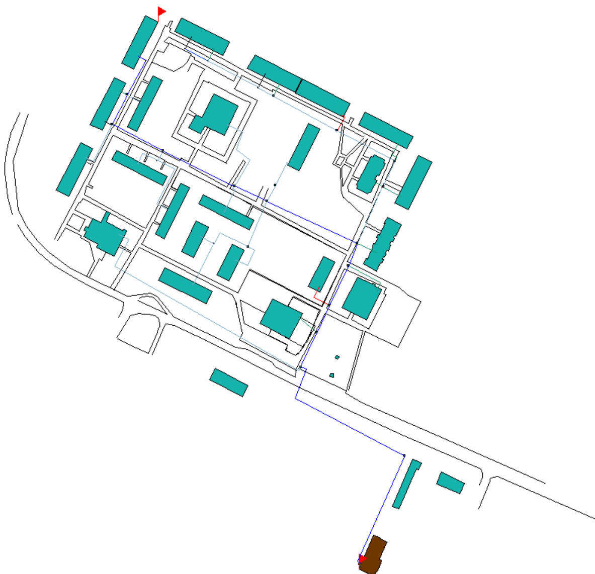
Рисунок 16 – Путь для построения пьезометрического графика участка от котельной Су-62 до потребителя д. 12
