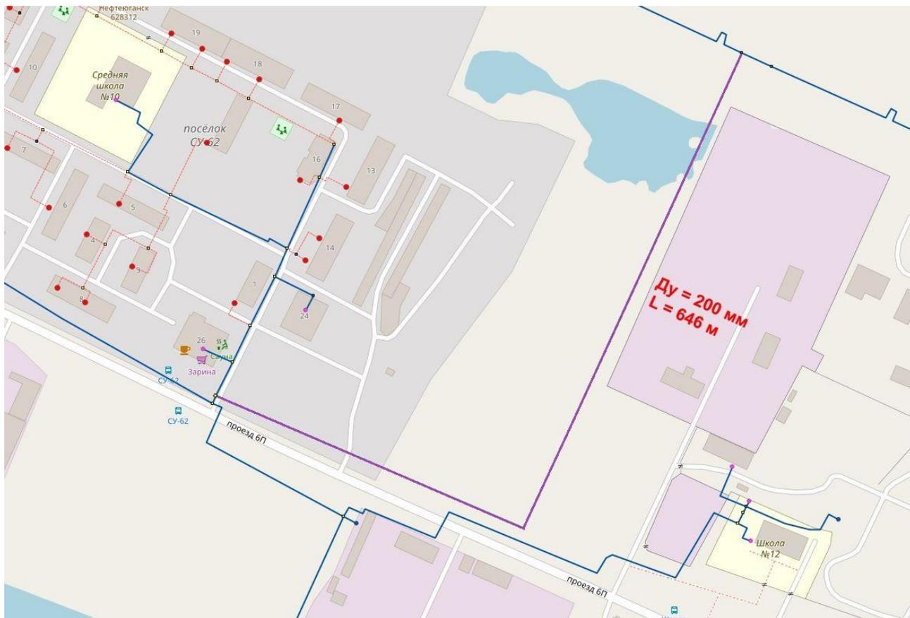
**Рисунок 9 - Планируемая перемычка на тепловых сетях котельных Юго-Западной и СУ-62**
